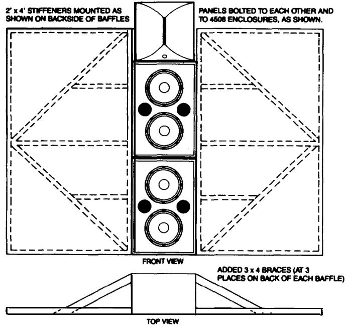
2' x 4' STIFFENERS MOUNTED AS SHOWN ON BACKSIDE OF BAFFLES
